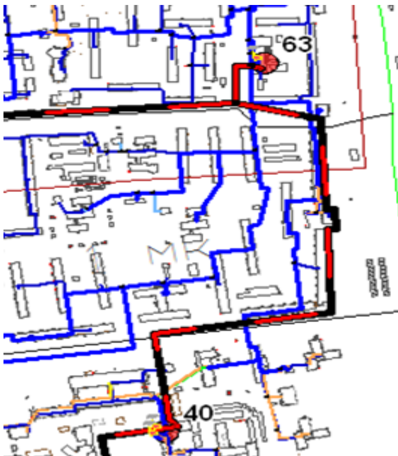
Рисунок 7.4.41 Схема прокладки трубопровода между котельными №40 и №63
