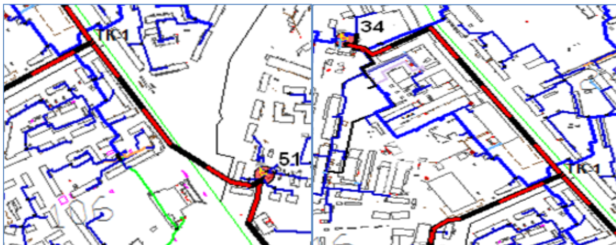
Рисунок 7.4.27 Схема прокладки трубопровода между котельными №34 и №51
