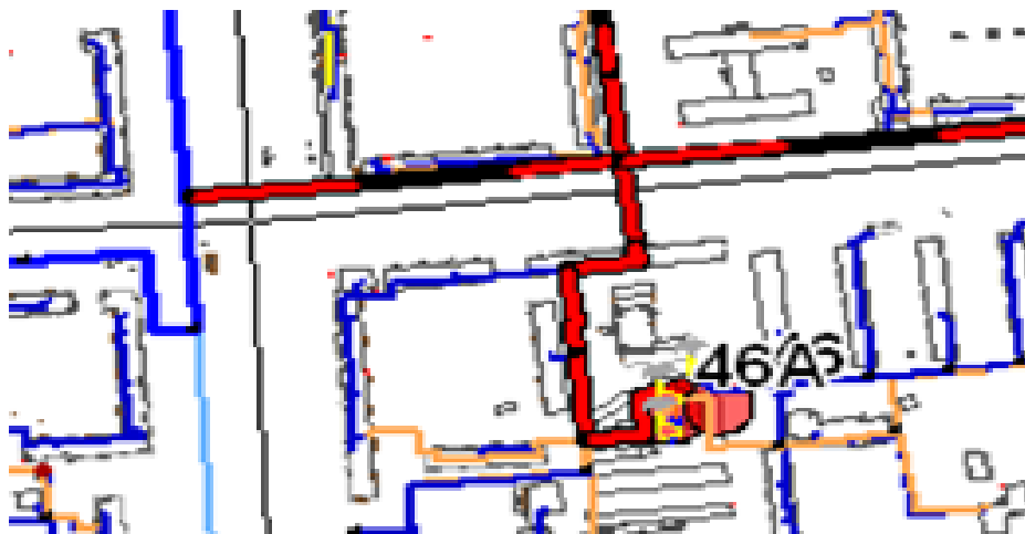
Рисунок 7.4.39 Схема прокладки трубопровода от котельной №46
