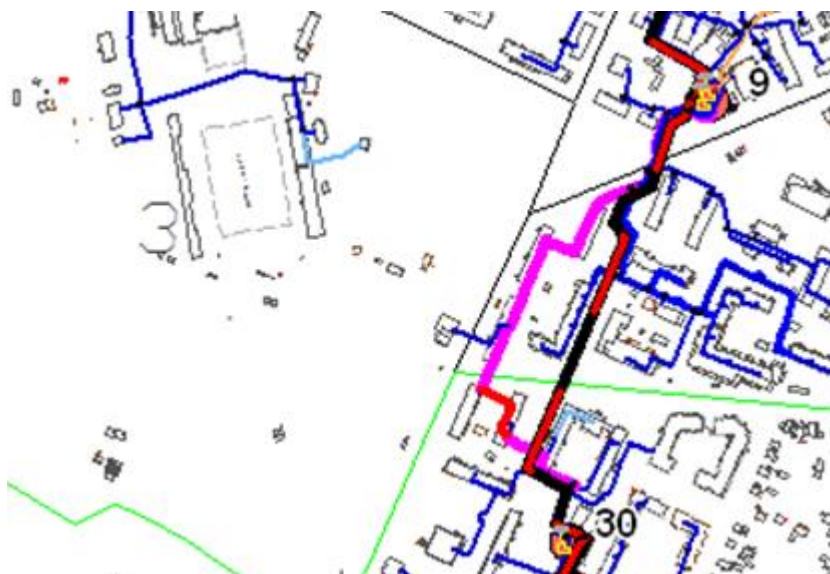
Рисунок 7.4.12 Схема прокладки трубопровода между котельными №30 и №9
