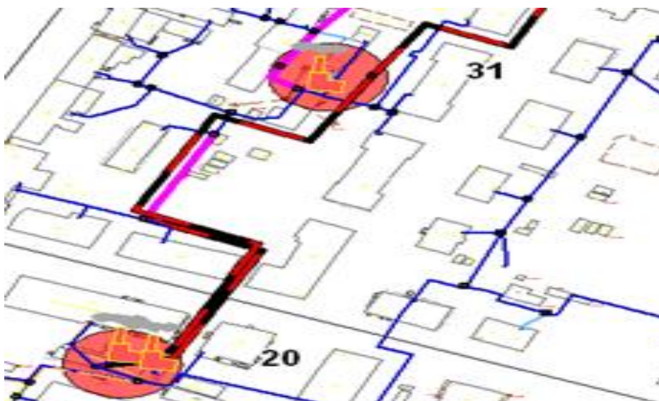
Рисунок 7.4.19 Схема прокладки трубопровода между котельными №31 и №20
