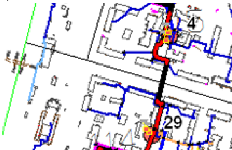
Рисунок 7.4.32 Схема прокладки трубопровода между котельными №4 и №29
