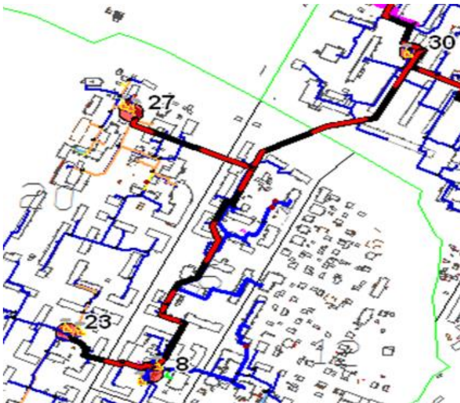
Рисунок 7.4.3 Схема прокладки трубопровода от котельной №30 до котельной №8
