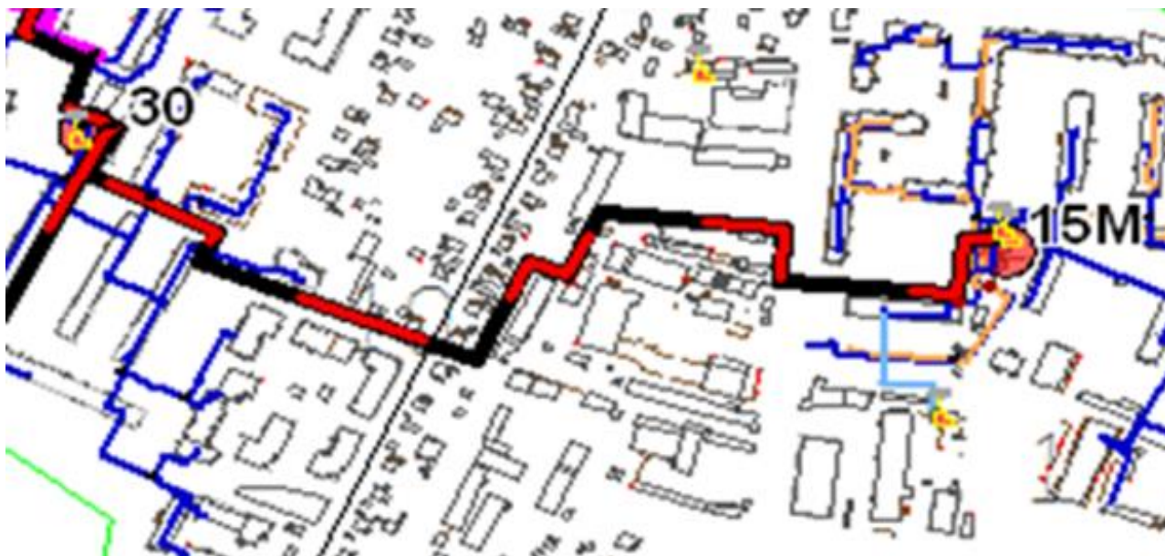
Рисунок 7.4.6 Схема прокладки трубопровода от котельной №15 до котельной №30
