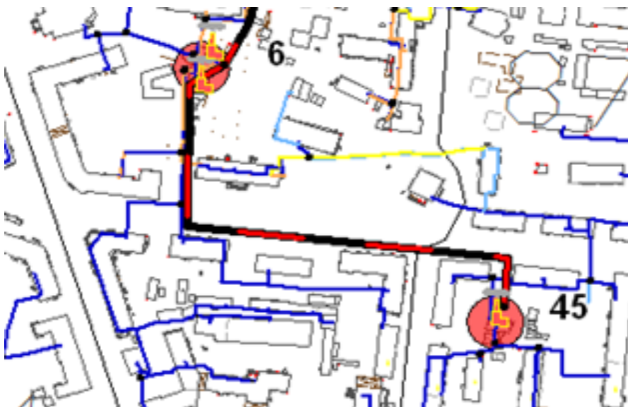
Рисунок 7.4.30 Схема прокладки трубопровода между котельными №6 и №45
